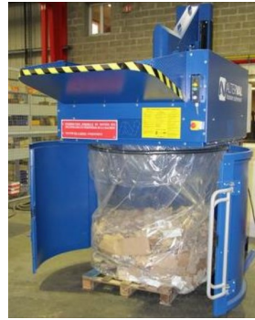
Un compacteur à la fin de l'opération
