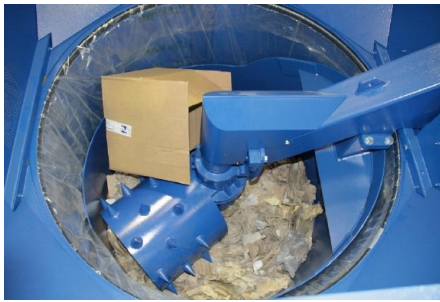
Vue intérieure d'un compacteur rotatif
